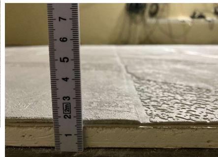
photo: détail coupe transversale du revêtement mural acoustique après collage du revêtement sur une plaque de plâtre BA13 pour l'essai 2
